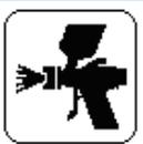
**Applicazione:** Con una pistola a spruzzo e ugelli monouso. Si raccomanda di usare la pistola con un regolatore di pressione o di aria per ottenere effetti diversi.
