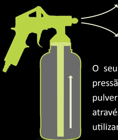
O seu funcionamento é baseado em pressão negativa. O produto a ser pulverizado é aspirado e pulverizado através do bocal pelo fluxo de ar, utilizando plenamente o seu conteúdo.
