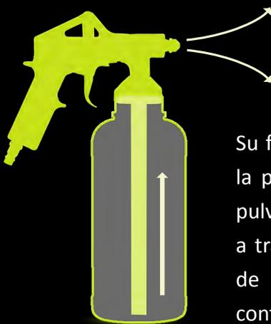
Su funcionamiento está basado en la presión negativa. El producto a pulverizar es aspirado y pulverizado a través de la boquilla por el flujo de aire, aprovechado todo su contenido.
